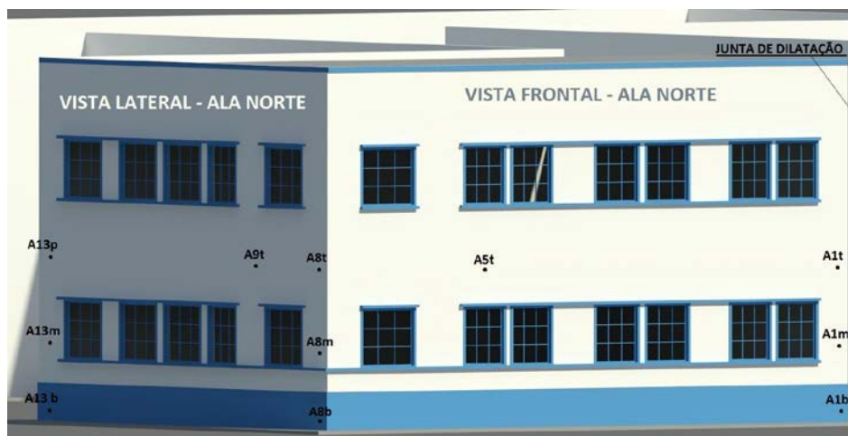
Figura 4 – Pontos de medição de deslocamento na Ala Norte.
