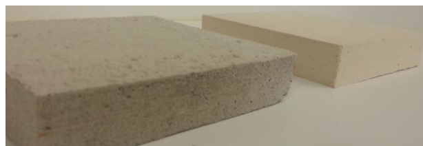
Figura 1: Reboco térmico, à esquerda, e argamassa de revestimento, à direita.
