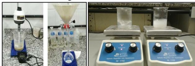
Figura 4: Agitação e filtração na extração do sulfato solúvel de amostra de concreto (esquerda) e soluções de sulfato de bário em agitador magnético (direita) (Fonte: os autores)
