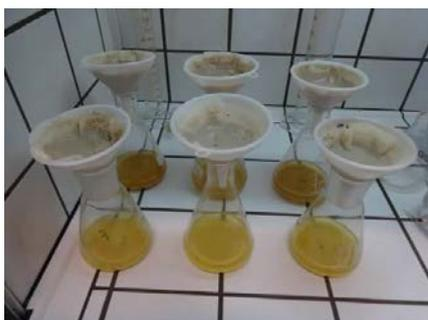
Figura 5 – Ensaios laboratoriais para determinação de rácio agregado/ligante
