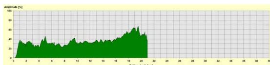
Figura 4 – Exemplo de registo de avaliação da estrutura de madeira com Resistograph
