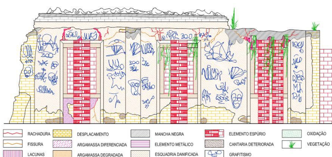
Figura 9 - Mapeamento de danos, 2017.
