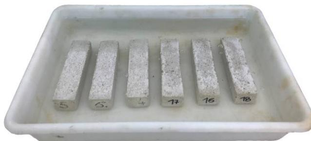
**Figura 2:** Imagen del ensayo de absorción por inmersión en agua de probetas de argamasa de 40 mm x 40 mm x 160 mm.
