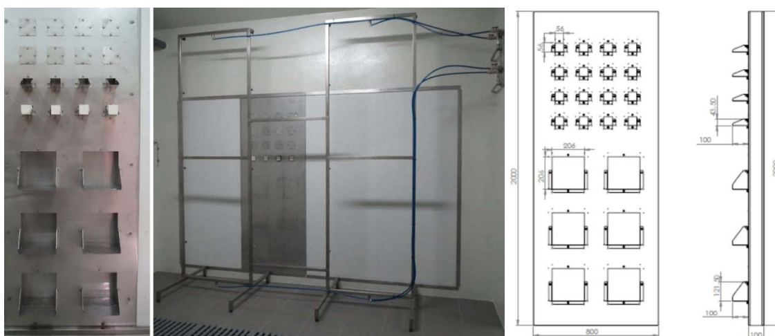
Figure 3 – Protótipo desenvolvido no LFC-FEUP para ensaios específicos de absorção.
