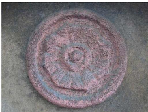
**Figura 7:** Detalhe da corrosão puntual. Observar as deposições de material particulado.
