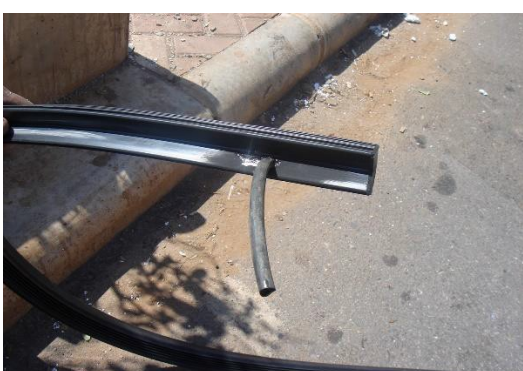
Figura 18: Válvula de pressurização (fonte: próprio autor)
