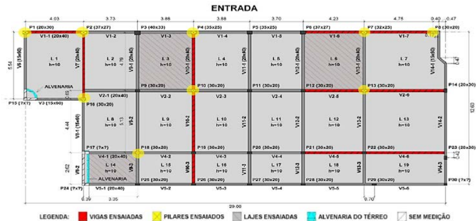
Figura 3: Elementos selecionados para os ensaios de pacometria e carbonatação do concreto.
