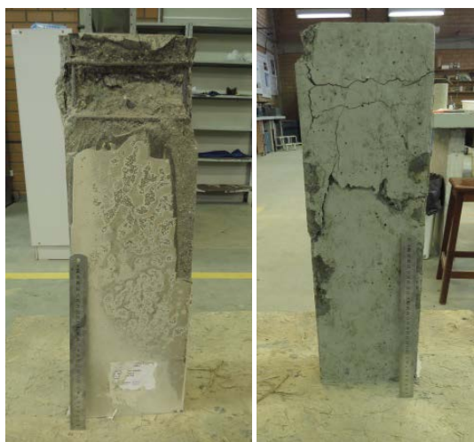
Figura 12: Ensaio realizado no pilar do modelo de recuperação 7.
