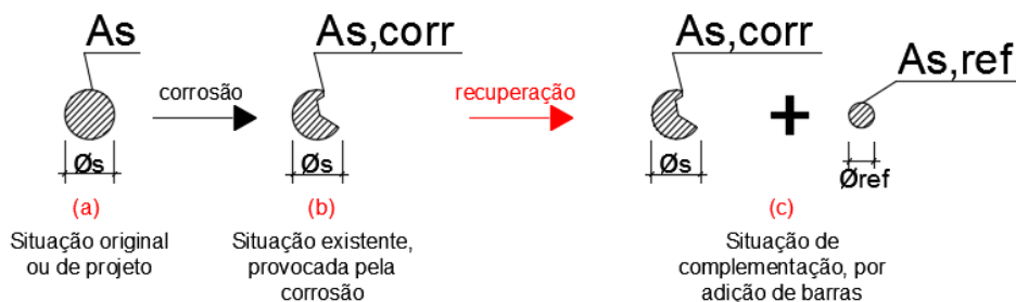
Figura 1: Reposição da seção original de aço por adição de novas barras. Fonte: Autor, 2017, baseado em SOUZA; RIPPER, 1998, p. 143
