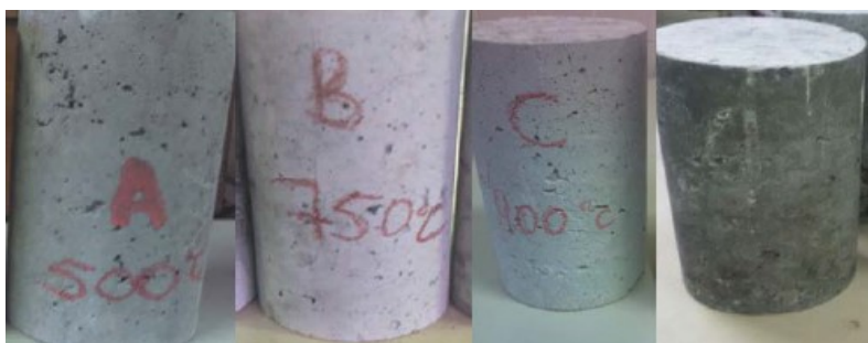
Figura 1 - Classificação dos corpos de prova em função da temperatura de exposição. Fonte: Autoria própria
