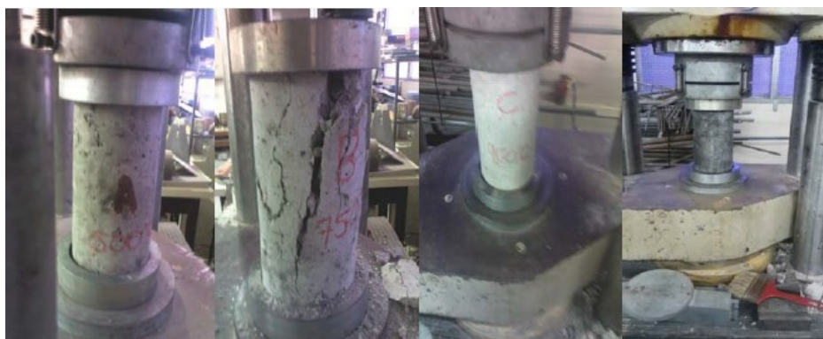
Figura 3 – Ensaio de compressão simples. Fonte: Autoria própria.
