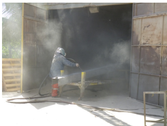
Figura 4: Jateamento das peças- Fonte: Acervo próprio.
