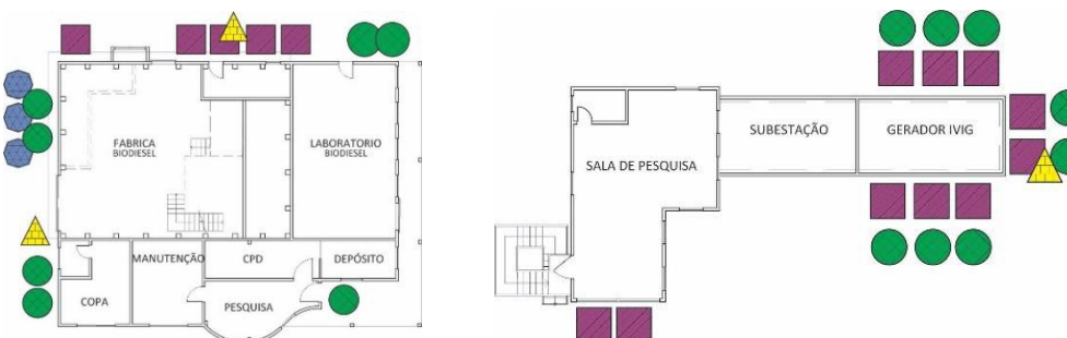
Figura 3: Planta Fábrica de Biodiesel e Planta Laboratório de Biodiesel – Mapeamento de Danos Fonte: Autora
