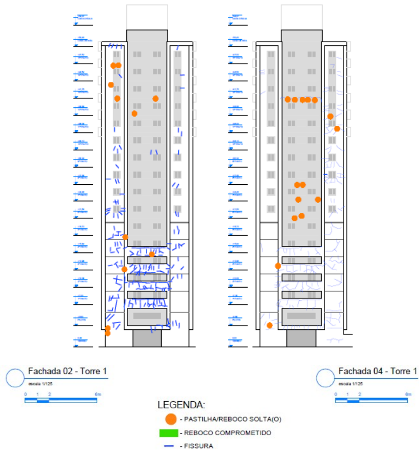
Figura 5: Croqui esquemático do mapeamento das manifestações patológicas (Fachada 2 e 4 – Laterais; Orientação: Leste e Oeste)
