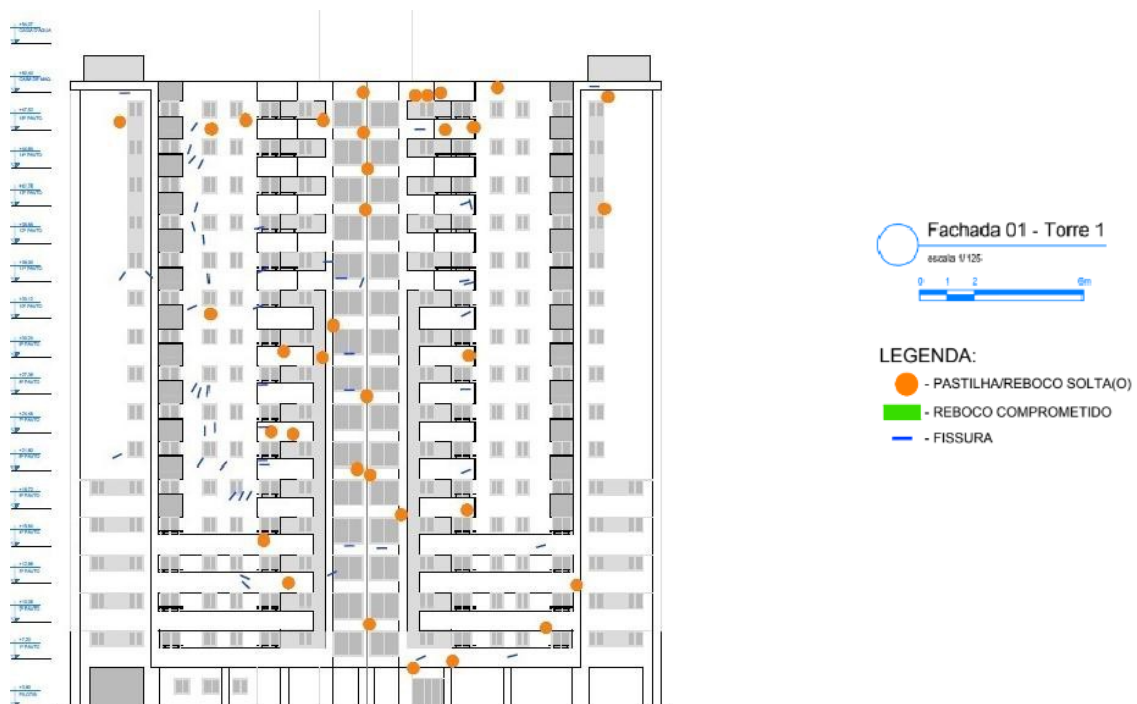
Figura 4: Croqui esquemático do mapeamento das manifestações patológicas (Fachada 1- Fontral; Orientação: Sul)
