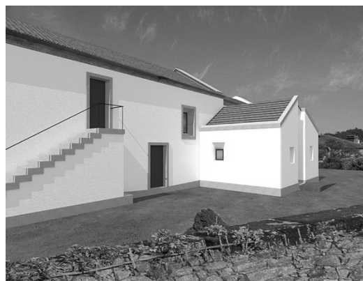
Fig. 8: Alçado lateral direito da Igreja de Gilmonde, com a simulação tridimensional da demolição da construção adossada e novo edifício da sacristia. Imagem do Autor.
