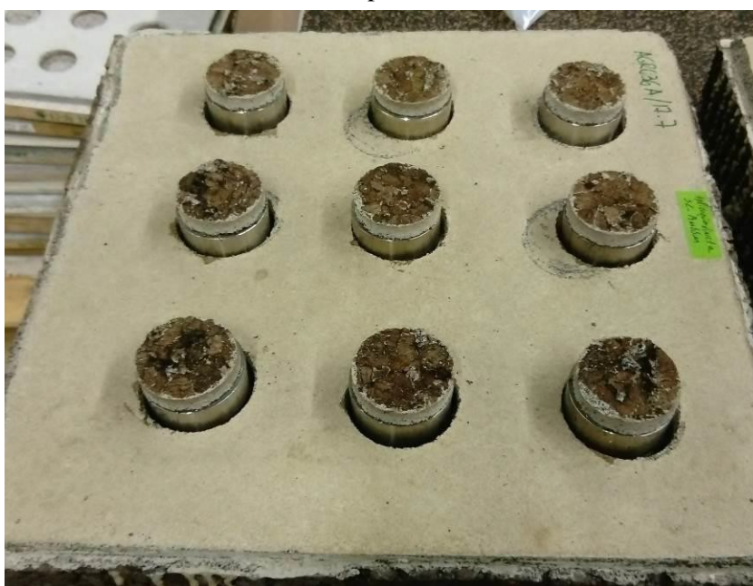
Figura 2: Resistência adesiva da betonilha com borracha em suporte de ICB (aplicação direta, sem primário).
