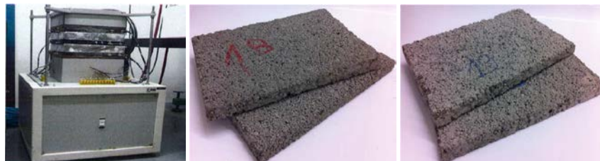
Figura 4: Exemplos do “set-up” de ensaio e das amostras de septos retirados dos blocos
