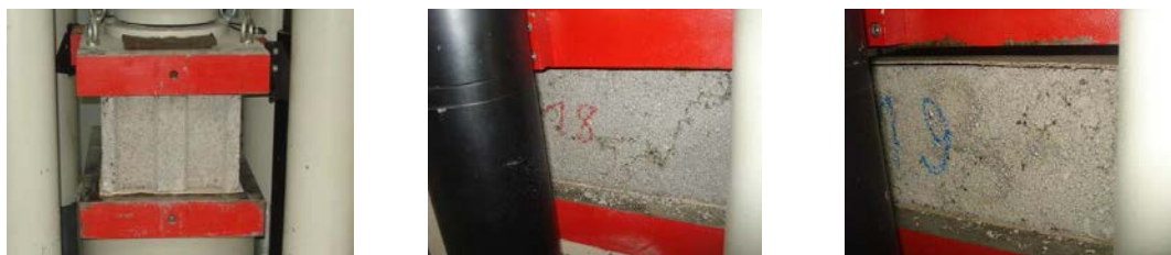
Figura 3: Exemplos do “set-up” de ensaio e da configuração de rotura após ensaios dos blocos
