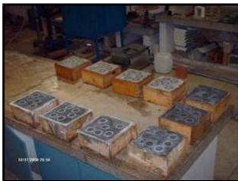
Figura 1: Caixotes apresentando revestimento, após corte
