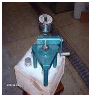
Figura 2: Equipamento usado no Ensaio de Aderência
