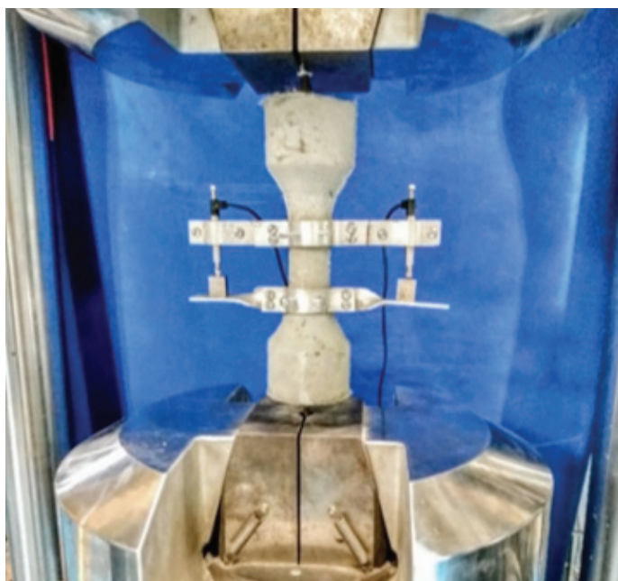
Figura 4 – Arranjo do ensaio de tração direta Fonte: própria do autor
